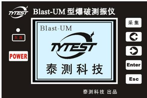
功能按键、液晶屏、欠压指示及工作状态指示。可通过按键实现操作控制；液晶屏显示信息。
